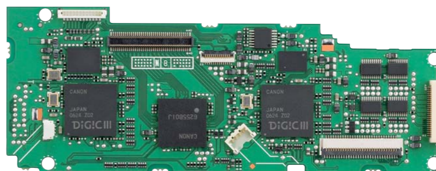
Due processori DIGIC III per una maggiore velocità e una qualità dell'immagine più elevata
